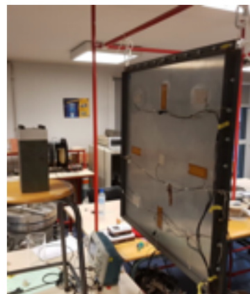
IMAGE 11. Schéma (a) et photo (b) de la plaque encastrée munie d'actionneurs piézoélectriques.
